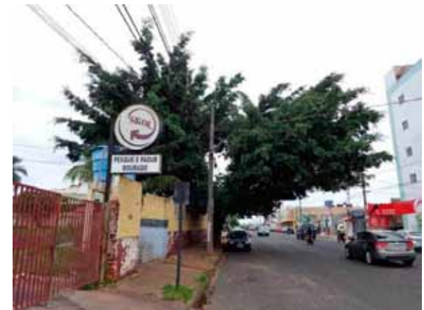
Figura 20. Exemplo de plantio inapropriado na calçada da Avenida. O conflito é aéreo com a rede elétrica, como no piso, com a destruição do pavimento pelas raízes. Fonte: Matheus Maramaldo.
