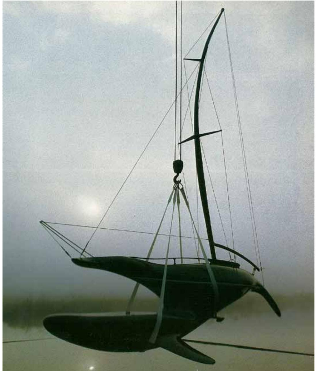
Poética também, além de extremamente simbólica, é a silhueta do iate projetado em 1980 para a America's Cup (Fig. 10). Num revival dos iates de alta performance do passado, Colani retomou a forma curva dos mastros - abandonada anteriormente pelos antigos construtores devido ao seu alto custo de produção - e fundiu-a a uma configuração de casco que define assim:
