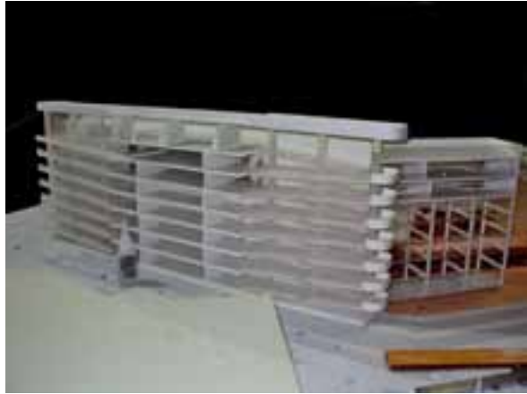
Figura 3. Detalhe das camadas horizontais de PVC e rampas. Foto: Autor, 2012
