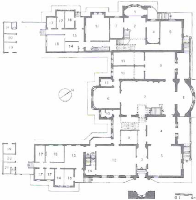
Figura 3. Planta do pavimento térreo. Fonte: HOMEM, 2010, p.190
