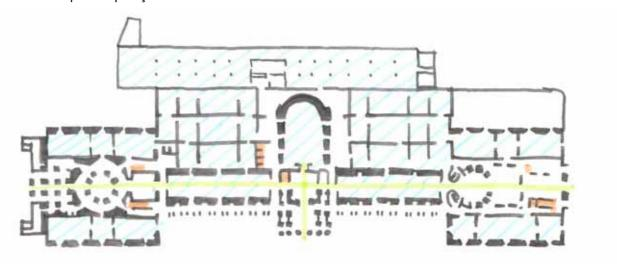
A planta (Figura 11) apresenta o resultado final da intervenção do arquiteto Rafael Moneo. Destacam-se os acessos e principais eixos de circulação, além da comunicação entre os espaços preexistentes e as áreas de ampliação.
