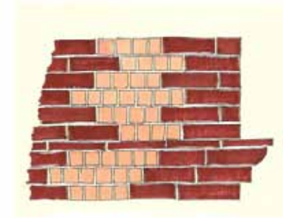
Albañilería intervenida con insertos
