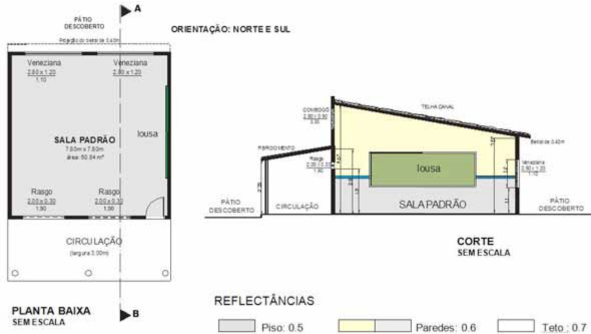
Figura 1 - Planta e corte da tipologia de sala de aula padrão adotada para a realização das medições, voltadas respectivamente para as orientações Norte e Sul. Fonte: Desenho do autor (2013)
