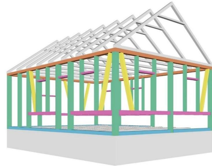
Figura 4. Princípio construtivo básico de estruturas enxaimel Fachwerk<sup>6</sup> (KOTTJÉ, 2008).
