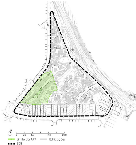
Figura 10. Levantamento planialtimétrico cadastral do Parque Centenário mostrando a declividade na área de APP e a presença de moradias, confrontando com lotes regulares ao sul. Fonte: Elaborado pelas autoras a partir de levantamento cedido pela FUMAS.
