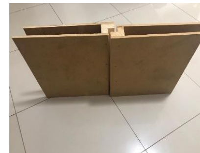
Figura 6: Protótipo do painel com encaixe. Fonte Elaborada pelos autores (2019).
